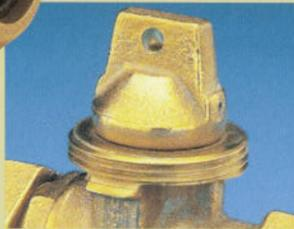
Las válvulas de bola de banqueta de 3/4" a 2" están disponibles con rosca tipo Minneapolis en el capacete. Las cajas de banqueta están diseñadas para roscar en las válvulas de bola de banqueta con rosca tipo Minneapolis produciendo un conjunto rígido. (Las roscas tienen ranuras que permiten drenar el agua de la caja).
