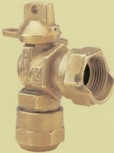
Las válvulas de bola Mueller® en ángulo para medidores utilizan un diseño único que provee un sello efectivo, con flujo en cualquier dirección. Aguas abajo del medidor se puede instalar una segunda válvula, que permite el cambio de medidor sin inundación del foso.
