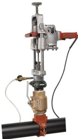
La herramienta para cortar orificios Vic-Tap II está diseñada para usarse con la unidad Vic-Tap II Mechanical-T Estilo 931, que es una combinación de la válvula Vic-Ball Estilo 920 Mechanical-T y Serie 726. El Vic-Tap II es capaz de conectarse a sistemas de tuberías de acero al carbono bajo presiones de hasta 500 psi/3450 kPa.
